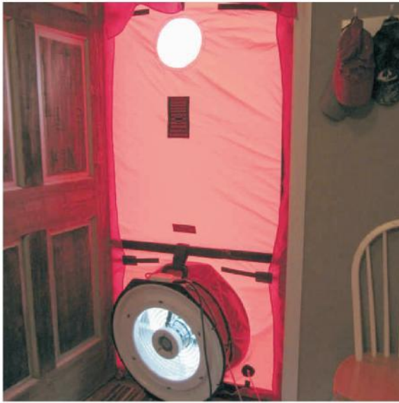
Door opening exhaust fan
